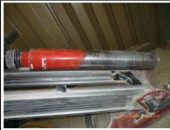
Foto 2: Broca diamantada de 2" utilizada en la extracción de núcleos en esta exploración
