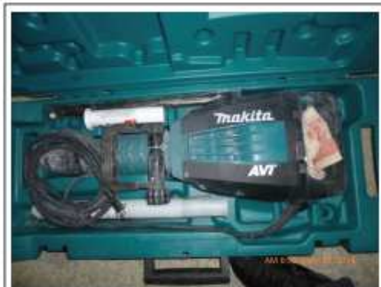
Foto 7: Taladro demoldador Makita HM121 4C para regatas en columnas
